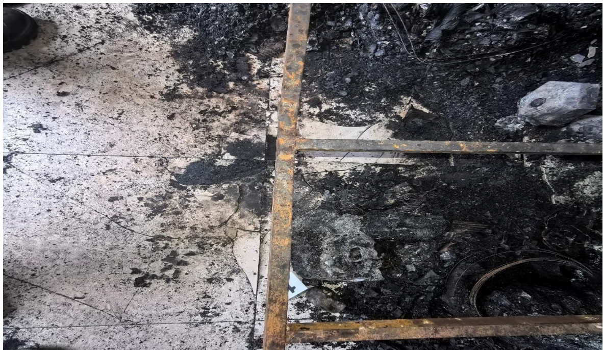
图片 7：对瓷砖炸裂处物品进行复原法勘验，此处及周边有装有电动自行车控制器的纸箱、两个哑铃的纸箱、快食面等食品的纸箱放置，未见锂离子电池等电池残骸，未见自燃性物质（俯拍）
